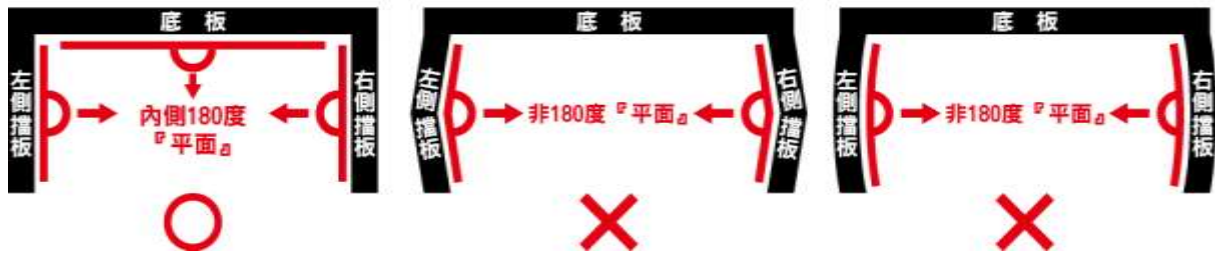
圖2、推球板示意圖(俯視)
