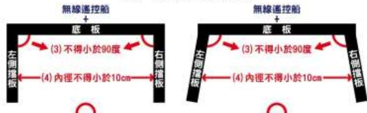
圖2、推球板示意圖(俯視)
